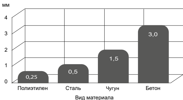
Рисунок 2. Шероховатость внутренней поверхности труб из различных материалов.
